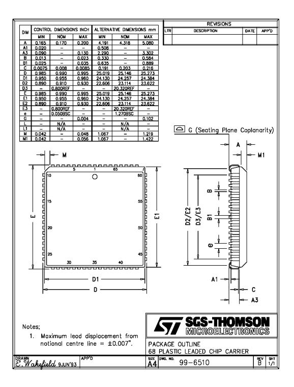
Figure 9.4 IMS T225 68 pin PLCC J-bend package dimensions
